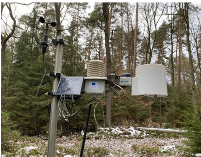
Klima- und Bodenfeuchte-Monitoringstation im Universitätswald Sailershausen bei Haßfurt,
